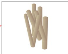
フィブリルが乱れた状態 ダメージにより、フィブリル間の結合が切断される。
